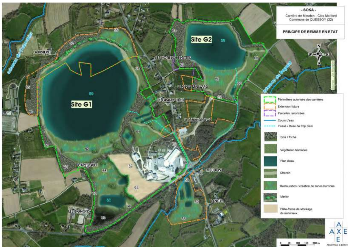
Figure 8: Localisation des zones humides lors de la remise en état.
